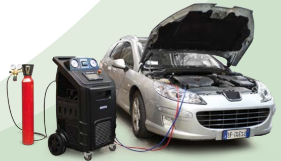
Nitrojen Gazı ile Kaçak Kontrol
